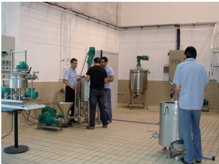
Adición de sólidos por tolva. Addició de sòlids per tremuja. Solids addition through the hopper.
