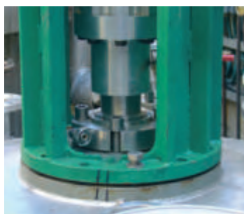
Cierre mecánico doble de cartucho lubricado.
